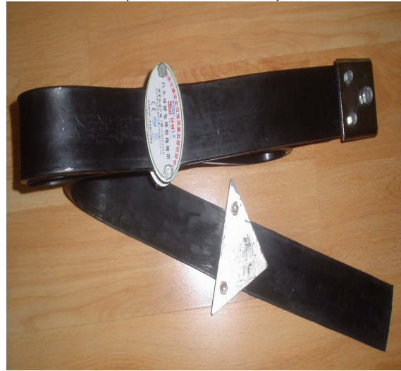
Hareket sırasında gerilim boşaltma bandı Yakıt tankeri statik elektrik iletkeni
